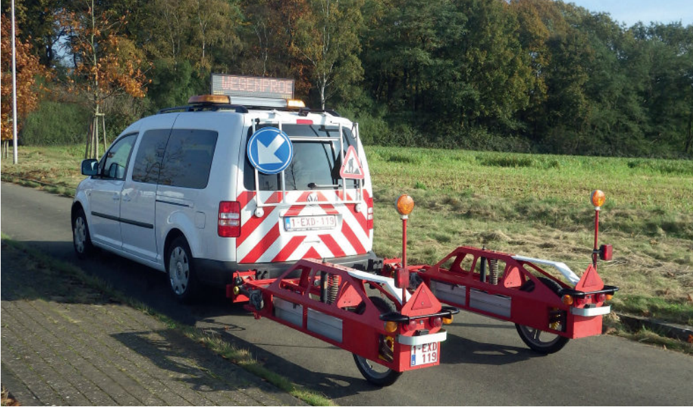
Yüzey profili ölçüm cihazları: APL profilometre ve bisiklet yolları için hafif profilometre
