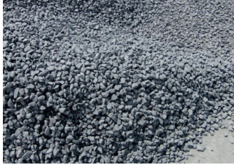
Kaliteli bir kaplama betonu için uygun kırma taş ve kum gerekmektedir.
