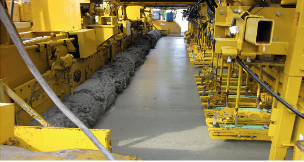
Kayma demiri yerleřtiriciler (Wirtgen- Gomaco - G&Z)
