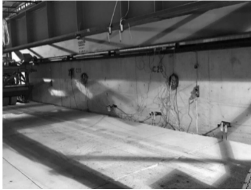
Şekil 11. Yükleme tekerlekleri, LVDT'ler ve beton plaklar
