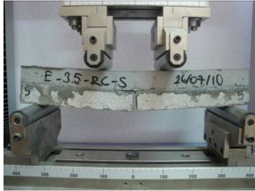
Şekil 8. Yansıma çatlaklı deneyi için dört noktalı eğilmede çekme testi
