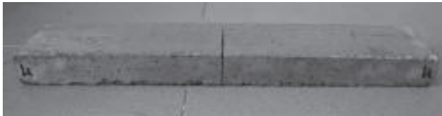
Şekil 7. Yansıma çatlağı deneyi için hazırlanan ATB numunesi
