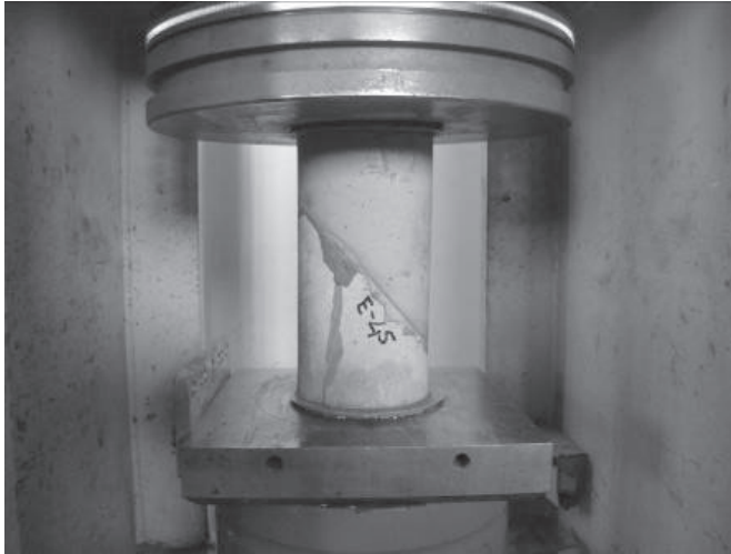
Şekil 5. Basınç yükü altındaki eğik kesme bağ dayanımı deney numunesi
