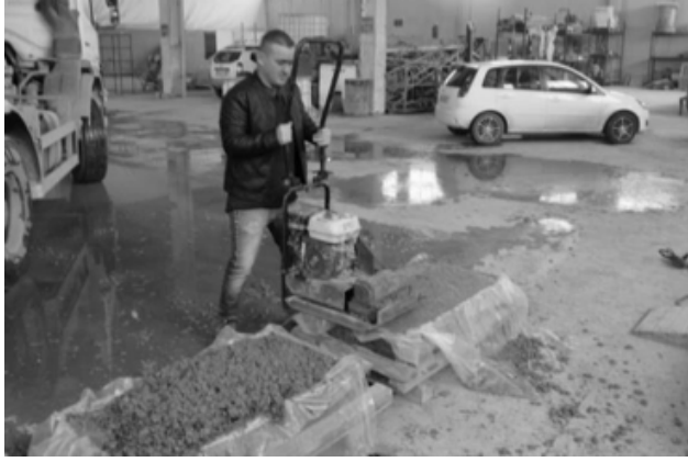
Şekil 2. Vibrasyonlu kompaktörle SSB'nin sıkıştırılması
