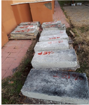
Şekil 3. SSB ve Geleneksel Beton numuneleri
