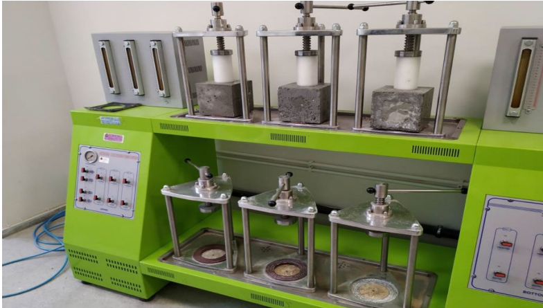
Şekil 2. Basınç altında su işleme derinliğinin tayini deneyi cihazı ve numuneler
