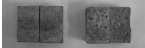
Şekil 10. Yarmada çekme bağ dayanımı deneyi sonrasında pürüzsüz ve pürüzlü numunelerin görünümü
