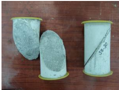
Şekil 9. Eğik kesme bağ dayanımı deneyi için hazırlanan numunelerin deney sonrası görünümü
