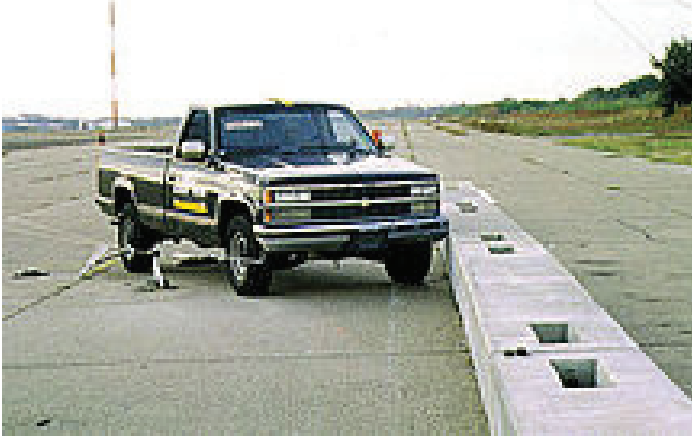
Şekil 8: Ters eğimli alçak bariyer
